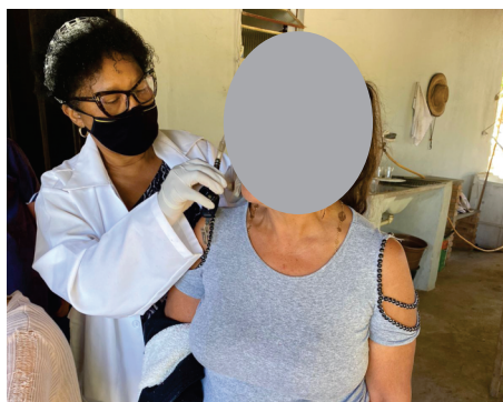
Instalação da bombinha que suga o ar e filtra os particulados para análise.
